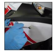
**ONLY TIGHTEN ALL SCREWS AFTER THE KIT** HAS BEEN COMPLETELY **MOUNTED**
